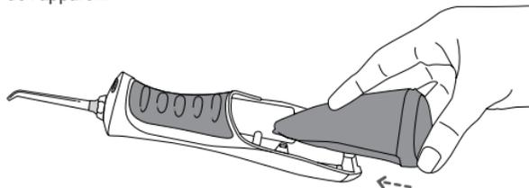
Pour réinstaller le réservoir sur la poignée d'alimentation, faites-le simplement glisser vers le sommet de l'appareil. Le réservoir s'emboîtera en place une fois complètement engagé.
