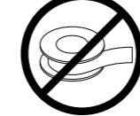
L'utilisation d'adhésif à tuyauterie n'est pas recommandée.
